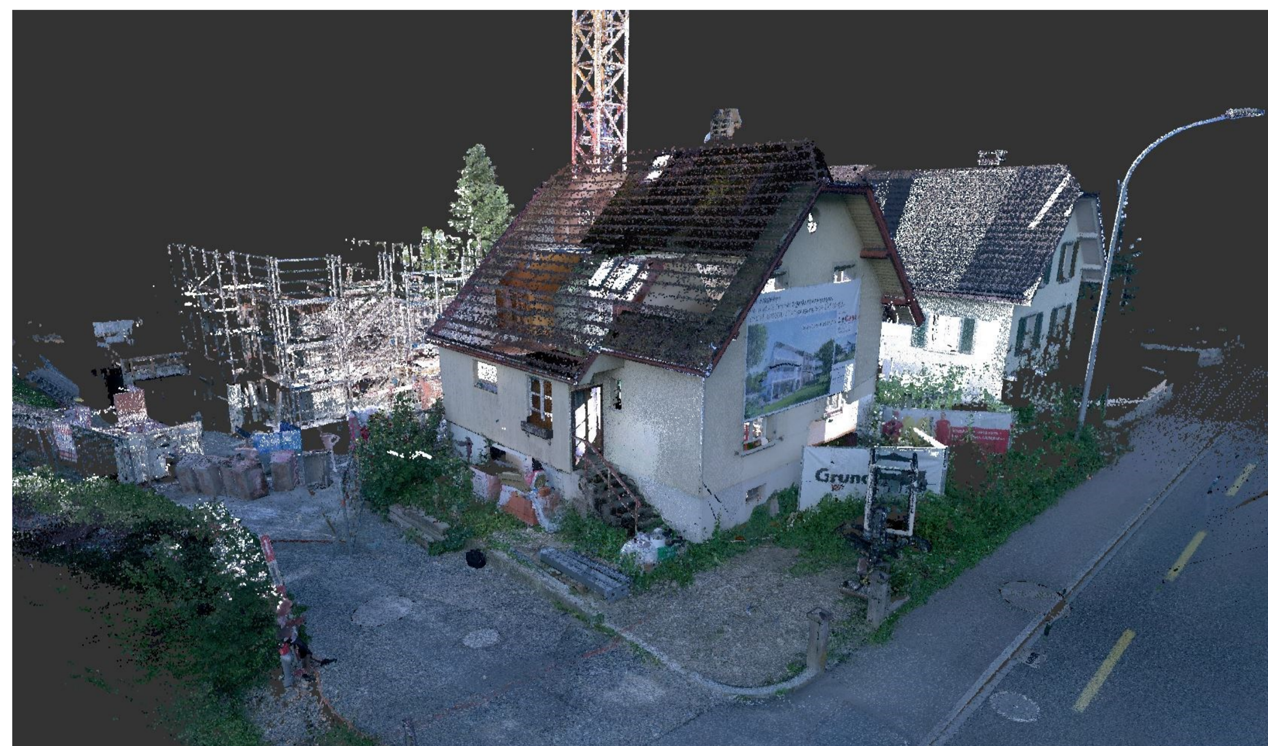
Ansicht der Punktwolke im Autodesk RECAP nach dem Scanning
