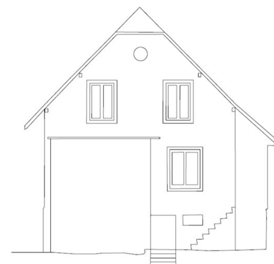
Erstellung Fassadenplan Ost mit Hilfe der Punktwolke
