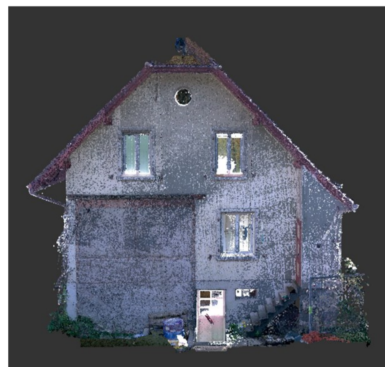
Erstellung Fassadenplan Ost mit Hilfe der Punktwolke
