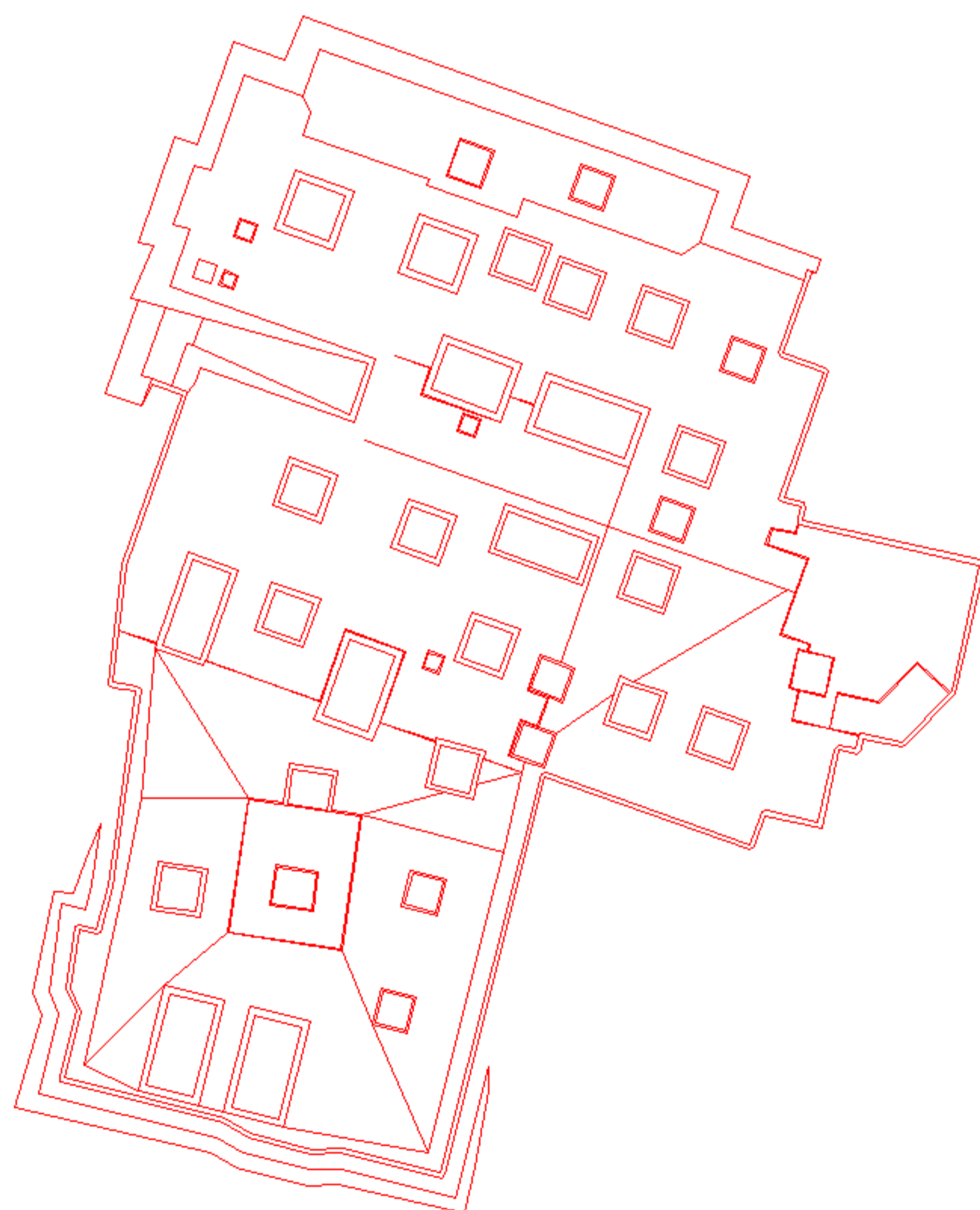
Alle Bruch- und Gefällskanten werden als 3D-Polylinien erfasst und dargestellt
