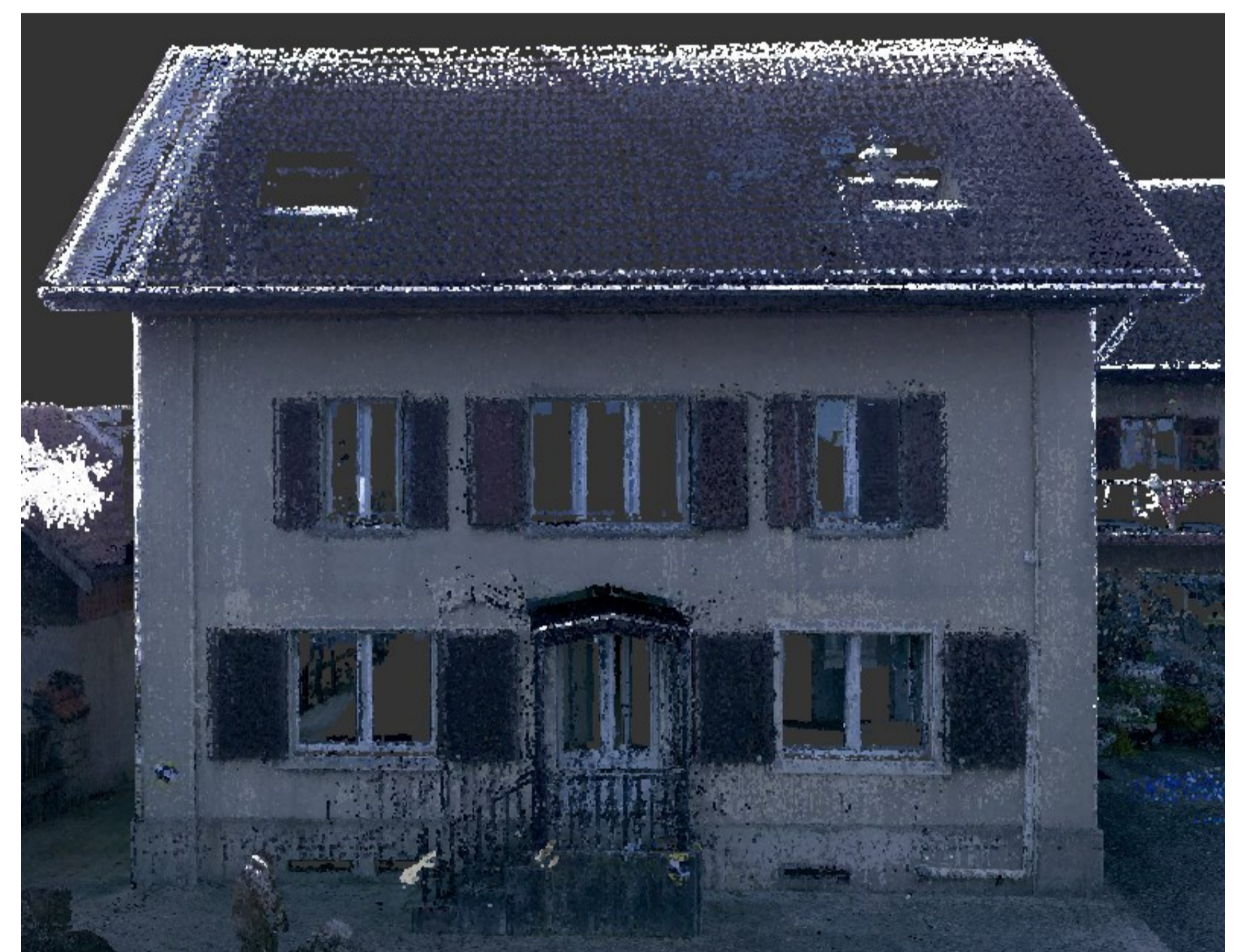
Ansicht der Punktwolke im Autodesk RECAP nach dem Scanning
