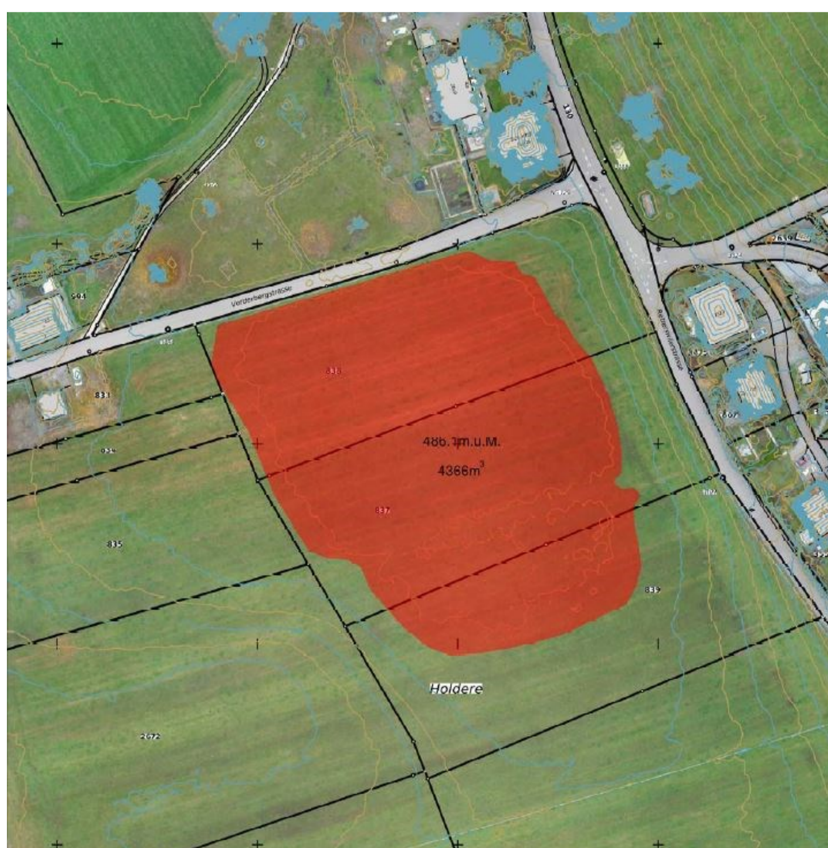
Wasserstand 486.10 m.ü.M. Fassungsvermögen des Retentionsbeckens: 4366m 3
