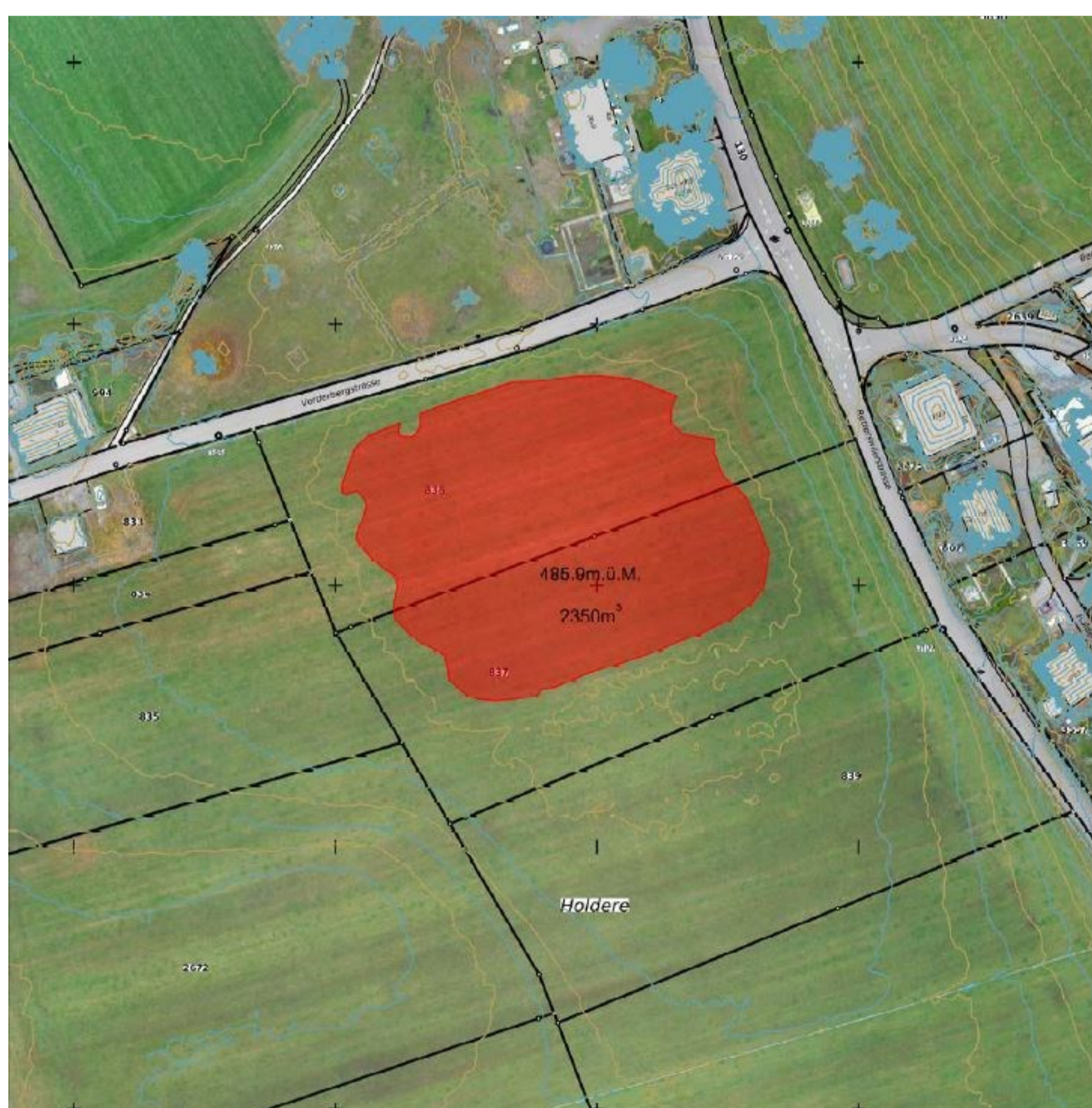
Wasserstand 485.90 m.ü.M. Fassungsvermögen des Retentionsbeckens: 2350m 3
