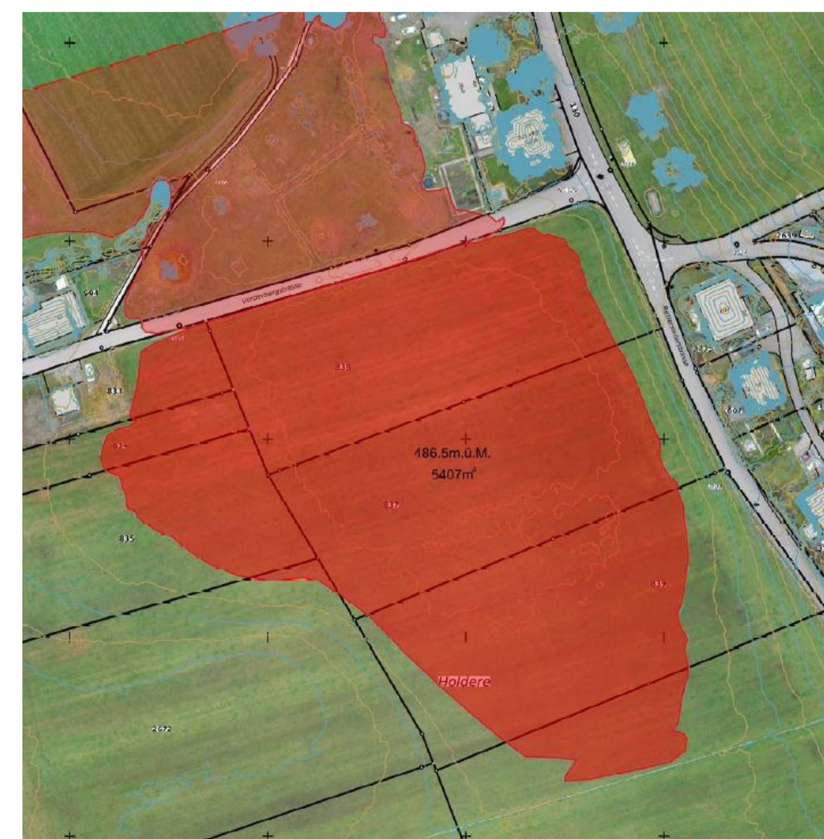
Wasserstand 486.50 m.ü.M. Fassungsvermögen des Retentionsbeckens: 5407m 3
