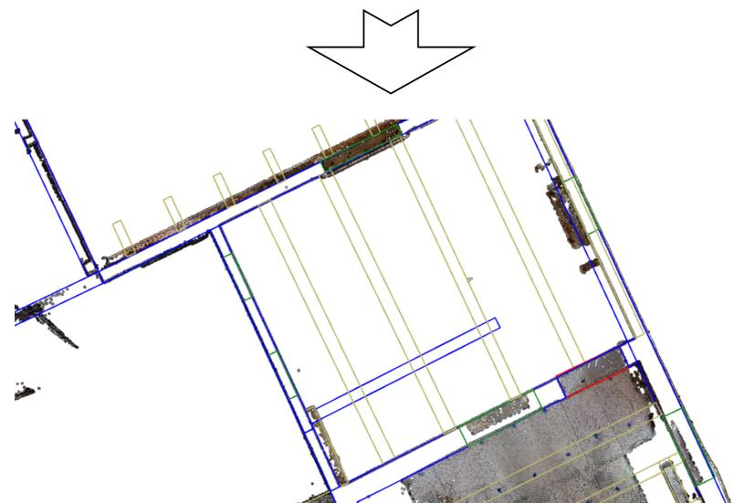
Konstruktion der Pläne mit hinterlegter Punktwolke in rmDATA 3DWorx
